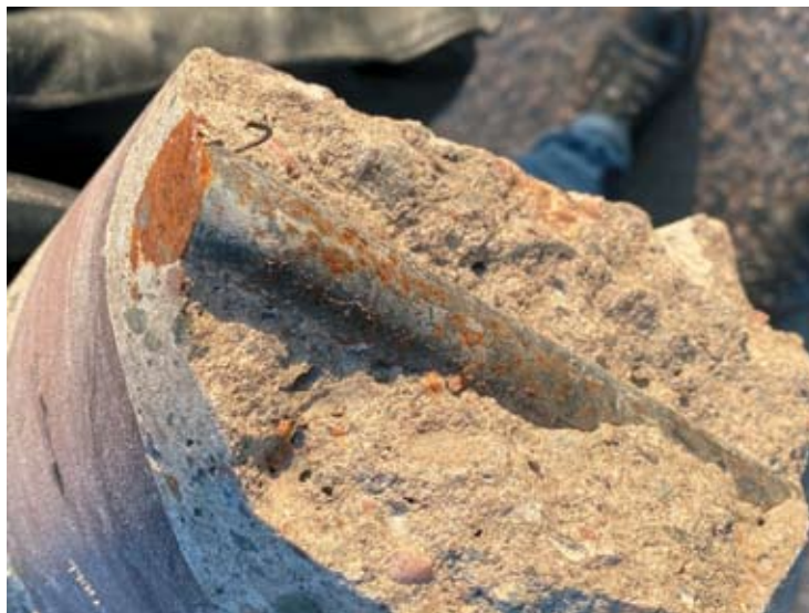
Рис. 2. Фрагмент гладкой арматуры
