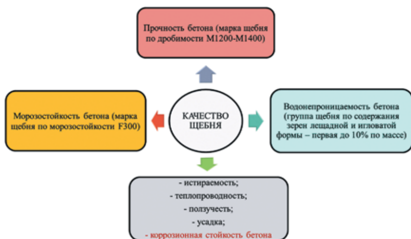
Рис. 1. Основные эксплуатационные свойства современного бетона, на которые влияет качество щебня
